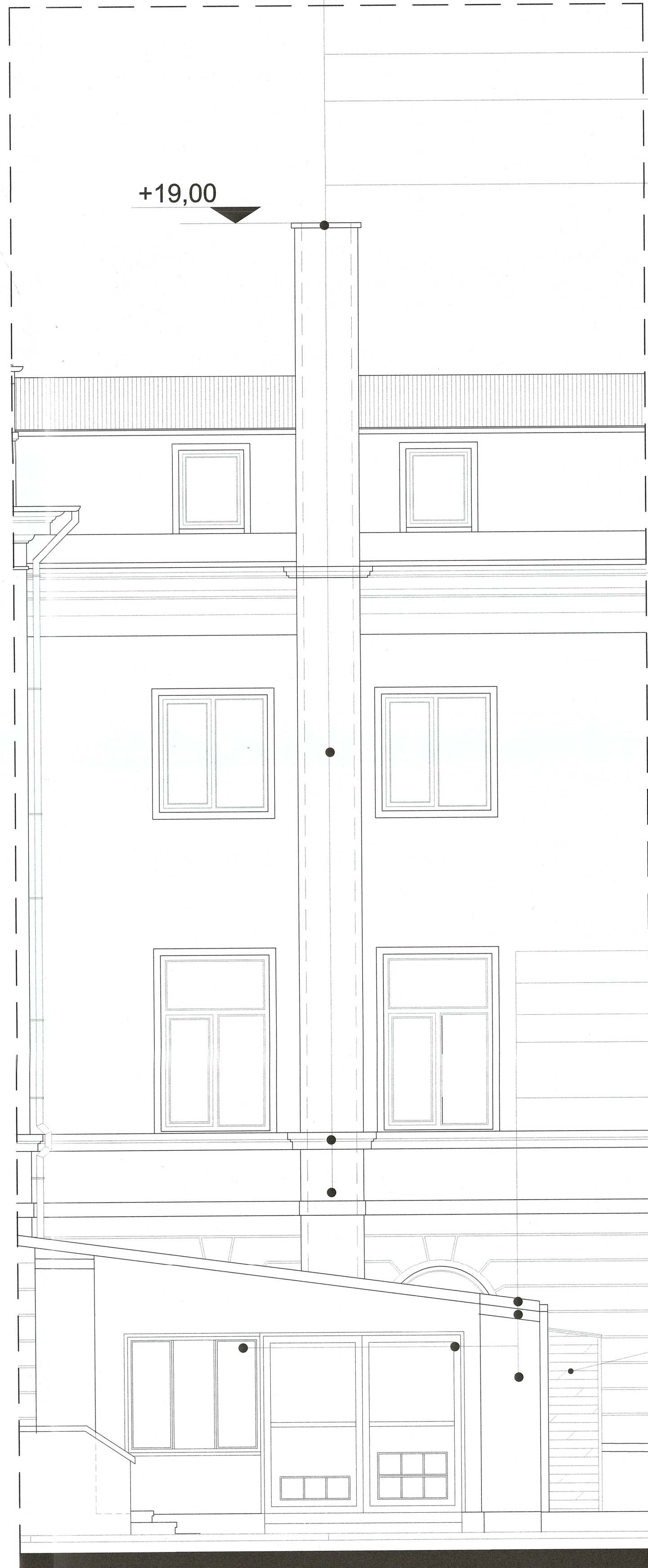
VEDERE PRINCIPALA CENTRALA TERMICA SI COS DE FUM
